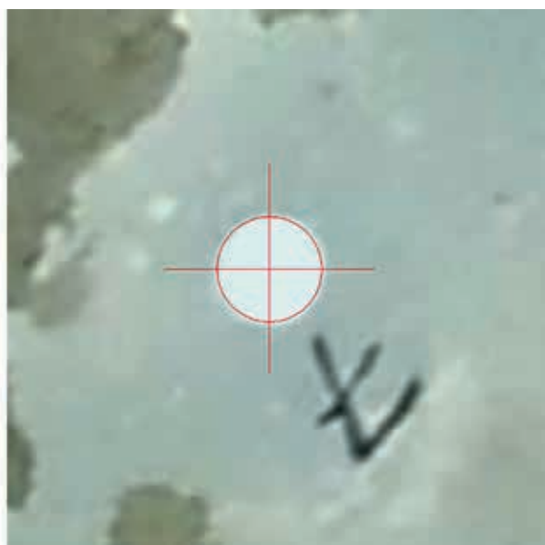
Slika 3 i 4: Kontrolna točka br. 7 fotografirana na terenu i s DOF-a (visina leta 30 m, DJI Phantom 4 Pro V2.0)
