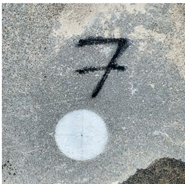
Slika 3 i 4: Kontrolna točka br. 7 fotografirana na terenu i s DOF-a (visina leta 30 m, DJI Phantom 4 Pro V2.0)
